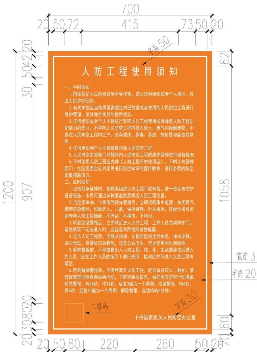
图 6.4-3 人防工程使用须知标识牌样式图
