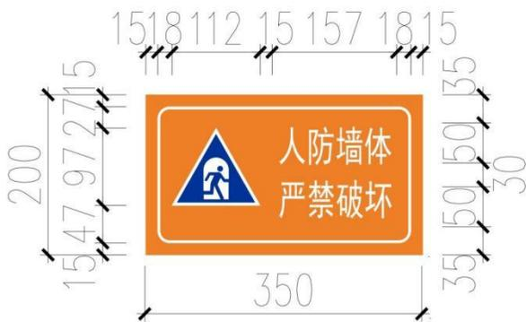
图 6.4-7-b “人防墙体严禁破坏”提示标识牌样式图
