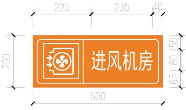
图 6.3-2 功能标识牌样式图（示例）
