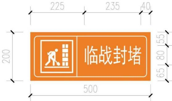
图 6.5-1 平战转换标识样式图（示例）
