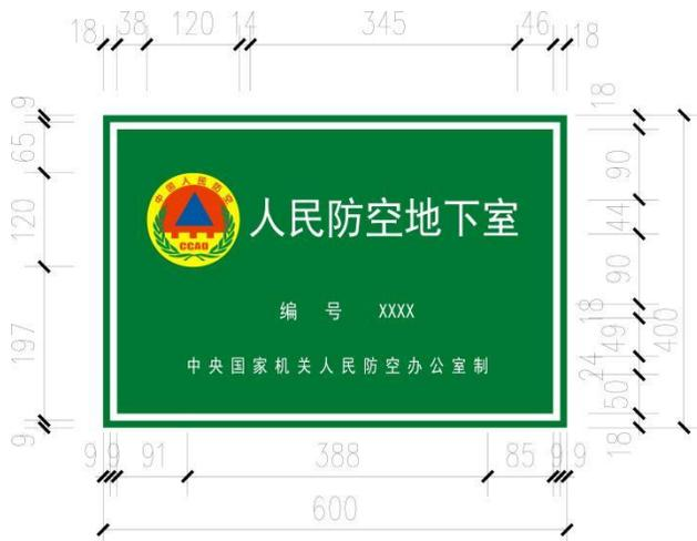
图 6.2-1-a 人防工程口部标识牌小尺寸样式图
