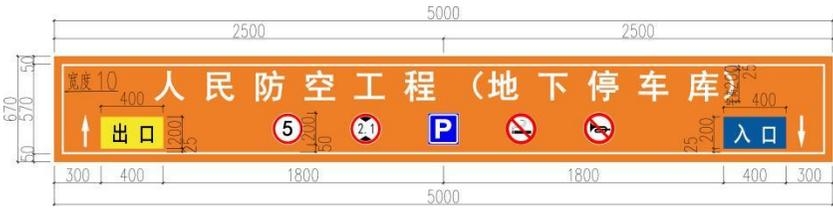
图 6.2-2 人防工程口部标识牌样式图
