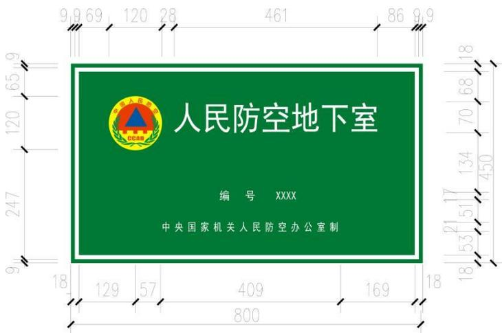
图 6.2-1-b 人防工程口部标识牌中尺寸样式图
