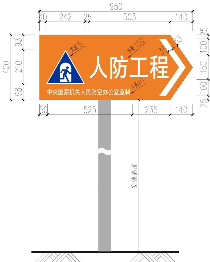
图 6.1-1 室外导向标识牌样式图
