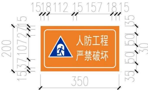
图 6.4-7-a “人防工程严禁破坏”提示标识牌样式图
