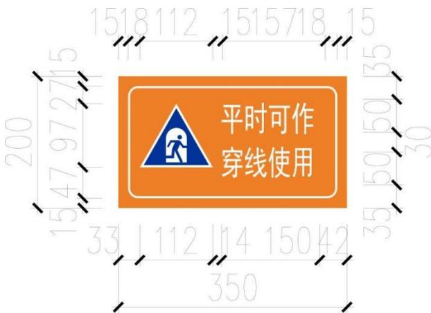
图 6.4- 7-d “平时可作穿线使用”提示标识牌样式图
