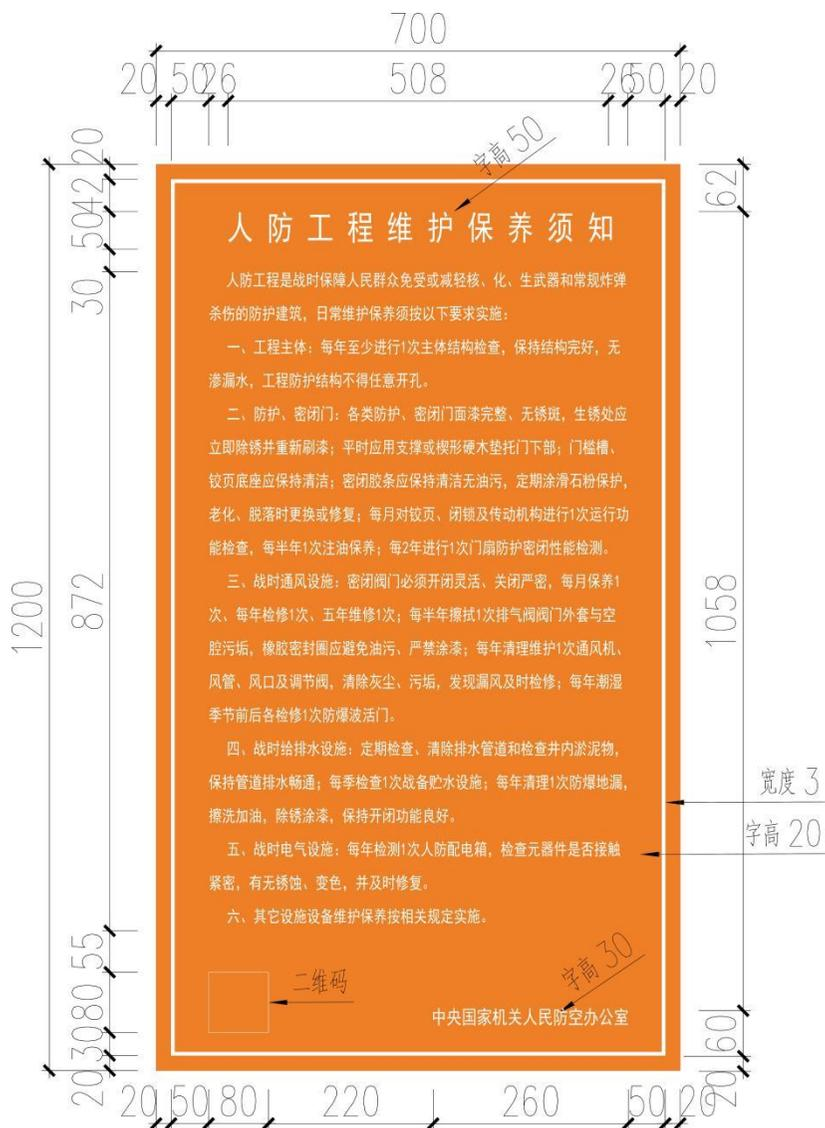
图 6.4-4 人防工程维护保养须知标识牌样式图
